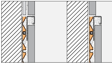
Einbauvariante: Wand-Begrenzungsprofil Schlüter®-QUADEC
