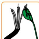
Attention ! Respecter la position des pinces ! La pince crocodile verte doit uniquement être raccordée au câble de mise à la terre (non isolé) !
