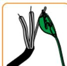
Atenção! O cabo de prova de cor verde com pinças de crocodilo deve-se conectar ao fio sem isolamento (terra).
