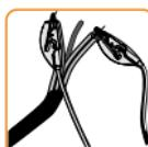
Attention ! Respecter la position des pinces ! Les pinces crocodile noires doivent uniquement être raccordées à des câbles de chauffage isolés (aller et retour) !
