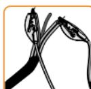
¡Atención! Los cables de prueba de color negro con pinzas de cocodrilo se deben conectar a los hilos con aislamiento (circuito cable calefactor).
