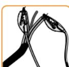
Figyelem! Ügyeljen a szorítókapcsokra! A fekete krokodil-csipeszeket kizárolag a szigetelt fűtőkábelre (az oda- és vissza-vezetékre) csatlakoztassa rá!
