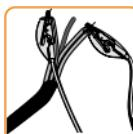
Pozor! Dávejte pozor při připojování krokosvork! Černé krokosvorky připojujte výhradně k izolovaným topným kabelům (přívodní a vratný vodič)!
