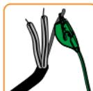
¡Atención! El cable de prueba de color verde con pinzas de cocodrilo se debe conectar al hilo sin aislamiento (tomatierra).
