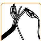
Dikkat! Kıskaç bağlantılarına dikkat edilmeli! Siyah kıskaçlı proplar, yalnızca izolasyonlu ısıtma kablolarına (iletken kablolar) bağlanabilir!
