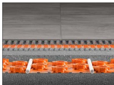
**15.** Für keramische Beläge/Naturstein: Verlegung der Verbundentkopplungsmatte Schlüter-DITRA in frischem Dünnbettmörtel nach Begehbarkeit des Estrichs. Bei Calciumsulfatestrich nach einer Restfeuchte von ≤ 2%.
