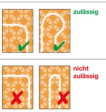
**10.** Beim Einbringen der systemzugehörigen Heizrohre mit Ø 10 mm sind diese in doppeltem Verlegeabstand bis zur Wendeschleife zu verlegen. Nach der Wende wird der Rücklauf (blaue Darstellung) im verbliebenen Freiraum mittig eingelegt. **Wichtig:** Umlenkung der Heizrohre gemäß Darstellung! Die Heizkreislänge beträgt max. 50 m.
