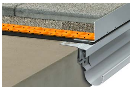
Przykład: podłoże żwirowe na Schlüter-TROBA
