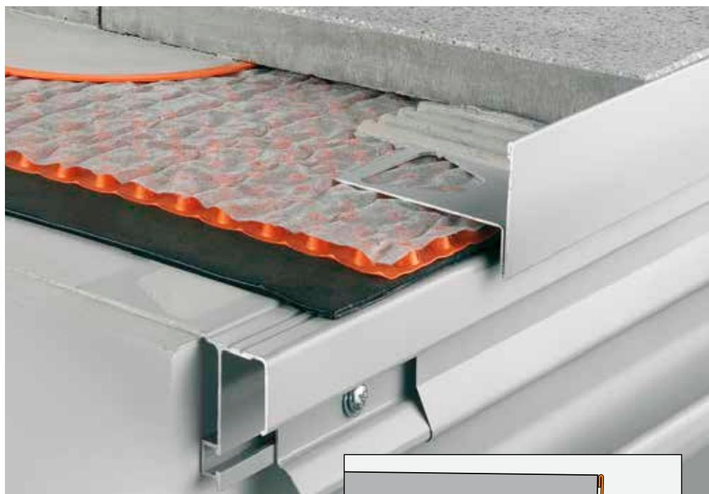
Schlüter-BARA-RT peut aussi être mis en œuvre lors de la réalisation d'une forme de pente en mortier, l'aillette de fixation à perforations trapézoïdales étant alors noyée dans le lit de mortier. Entre l'étanchéité et le mortier, il convient de poser la natte de drainage Schlüter-TROBA-PLUS afin d'éviter l'accumulation d'eau dans le mortier.
