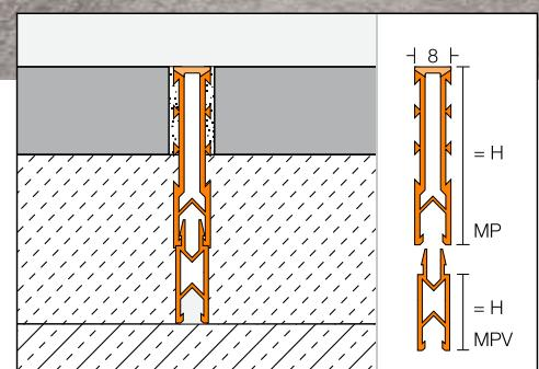
Schlüter-DILEX-MP/ -MPV se utiliza como junta de dilatación en los pavimentos cerámicos colocados sobre recocido de mortero. El perfil divide el pavimento en zonas independientes, y mediante su parte central fabricada en CPE flexible compensa las cargas debidas a la compresión.
