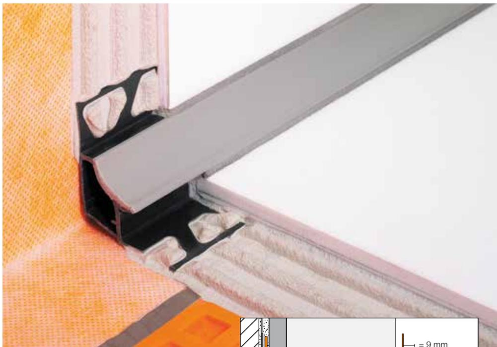
Le choix du profilé Schlüter®-DILEX-HK doit être déterminé au cas par cas, en fonction des contraintes chimiques, mécaniques et autres prévues. La gorge en CPE souple résiste aux U.V. et est exempte de plastifiants.
