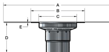
**Acier inoxydable avec sortie sans collet de 50 mm (2")**
