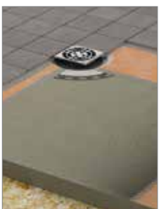
Base de mortero
