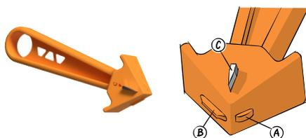
L'outil a un usage double : le nettoyage de la rainure (C), puis l'installation facile de la bande DILEX-FIS (A+B).
