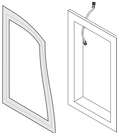
S výklenky Schlüter®-KERDI-BOARD-NLT se mohou vytvářet výklenky a odkládací místa s akcentovým osvětlením. LED-modul lze napájet přes integrovanou kabelovou průchodku, která je již opatřena připojovací kabelem s překonfekcionovanými konektory typu plug-and-play. Poloha a konstrukce kabelové průchodky je přitom výhodná pro odborné utěsnění při použití v místnostech s občasným vlhkým prostředím. Pomocí přiložené těsnící manžety je možné chránit připojovací spáry proti vnikání vlhkosti.
