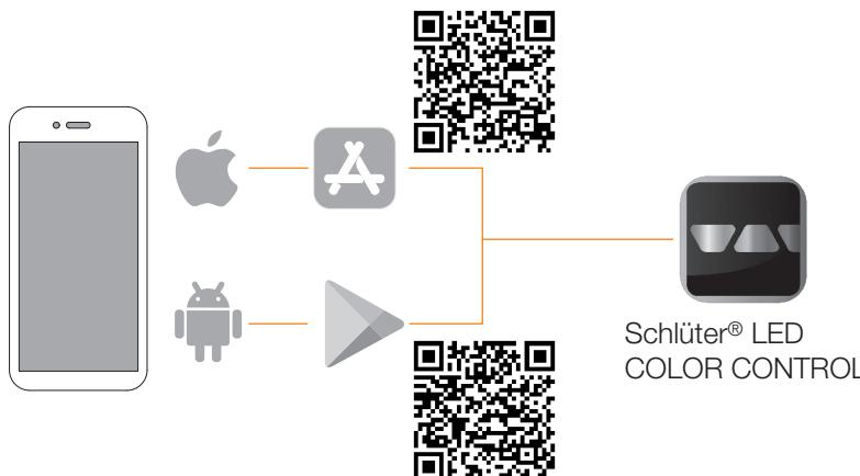
Schlüter®-LED-COLOR-CONTROL es una aplicación para dispositivos móviles que puede utilizarse para controlar el sistema LED.
