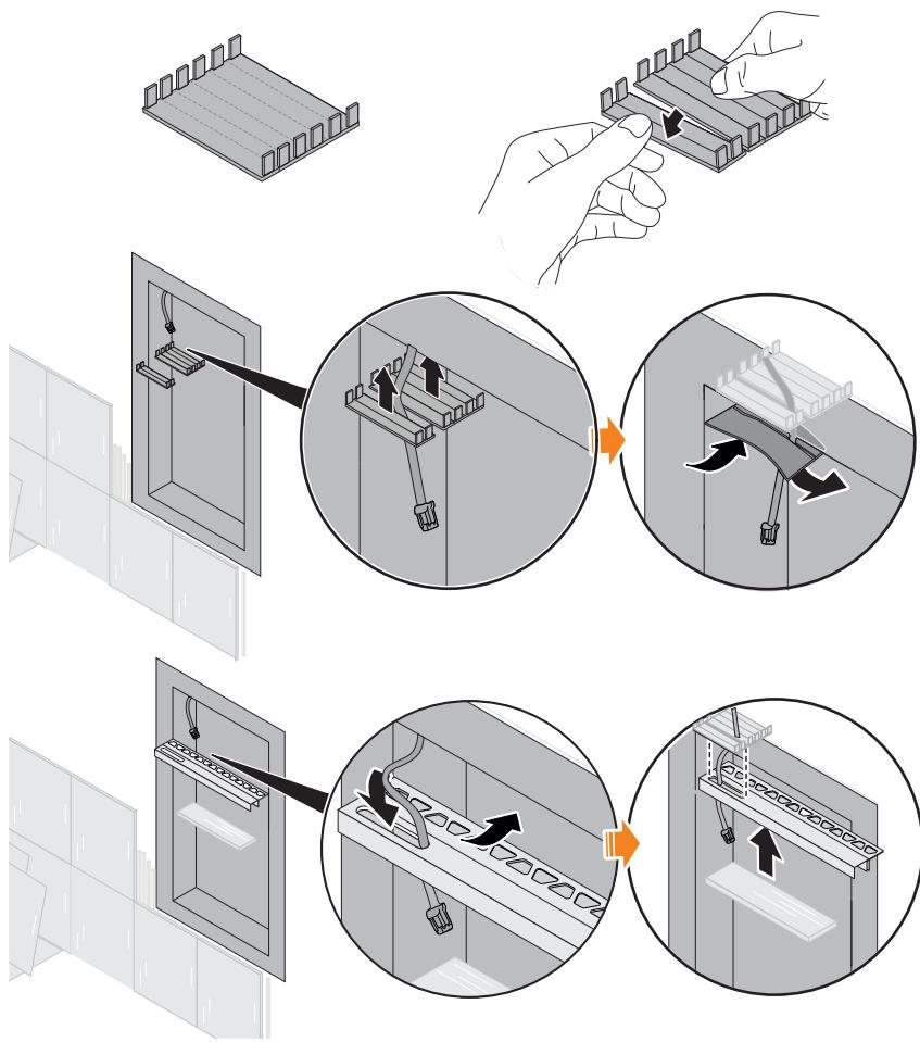
La position du profilé de montage peut être adaptée en séparant le couvercle de la prise de passage à l'un des points de séparation prévus. Un espace peut ainsi être créé lors de l'insertion des différentes parties de la prise de passage. La position de l'espace détermine la profondeur à laquelle le profilé de montage est enfoncé dans la niche.
