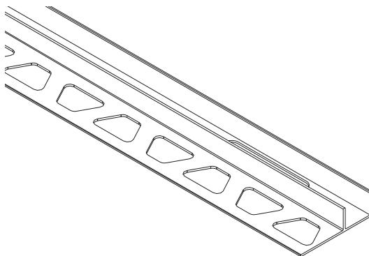
Aufnahmeprofile dienen zur mechanischen Aufnahme der LED-Schläuche. Aufnahmeprofile können als Abschlussleisten für geflieste Bereiche verwendet werden. Sie sind in zwei unterschiedlichen Profilbreiten und diversen Längen erhältlich.
