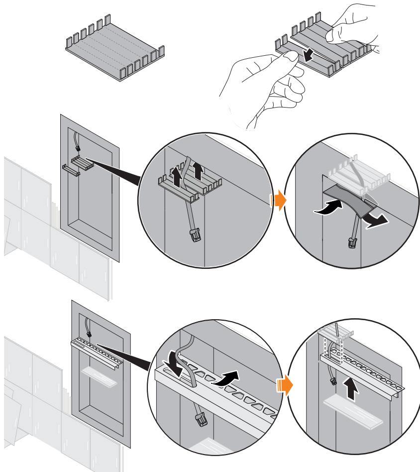
La posición del perfil de soporte puede adaptarse dividiendo la tapa de la caja de paso por uno de los puntos de corte previstos. Al colocar las partes separadas de la caja de paso se puede crear una hendidura. La posición de la hendidura predetermina la profundidad a la que se sumerge el perfil de soporte en el nicho.
