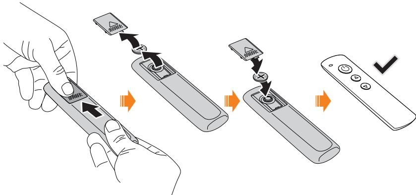
Sostituire una batteria scarica (» *Dati tecnici della batteria*» a pagina 308) come mostrato.
