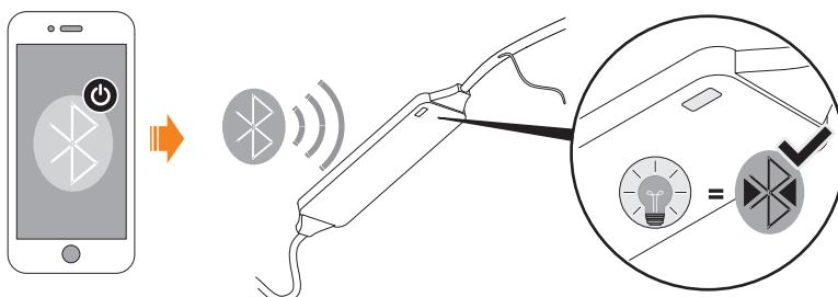
6. Stabilire una connessione Bluetooth tra il dispositivo mobile e il ricevitore Bluetooth secondo le specifiche del produttore del dispositivo.
