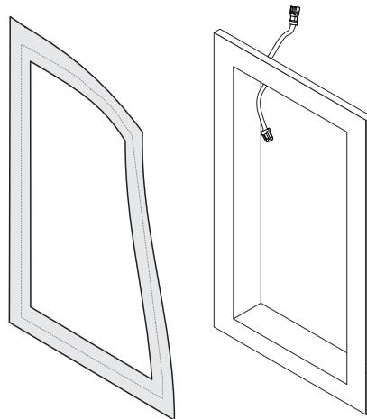
Med Schlüter®-KERDI-BOARD-NLT-nischer går det att montera nischer och förvaringsplatser med accentbelysning. Via en integrerad kabelgenomföring, som redan är förmonterad med en anslutningskabel med plug-and-play-kontakter, kan LED-modulen försörjas med spänning. Läget och monteringen av kabelgenomföringen gynnar en yrkesmässig tätning för användning i rum som tidvis är utsatta för fukt. Anslutningsfogen kan skydda mot inträngning av fukt med hjälp av den bifogade tätningen.
