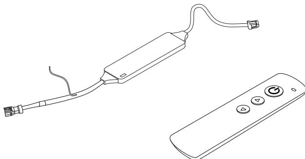
Bluetooth-modtageren (ikke indeholdt i leveringsomfanget) kan modtage den trådløse fjernbetjenings trådløse signaler og oprette en Bluetooth-forbindelse med en mobil slutenhed.
