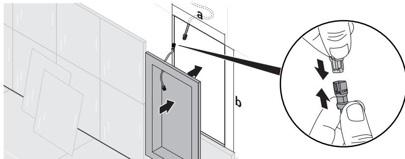
Para que mediante el nicho se pueda crear un estante integrado, la superficie exterior del nicho debe quedar enrasada con la pared en la que se empotra. La caja de paso instalada en el nicho siempre debe mirar hacia arriba en la posición de montaje.
