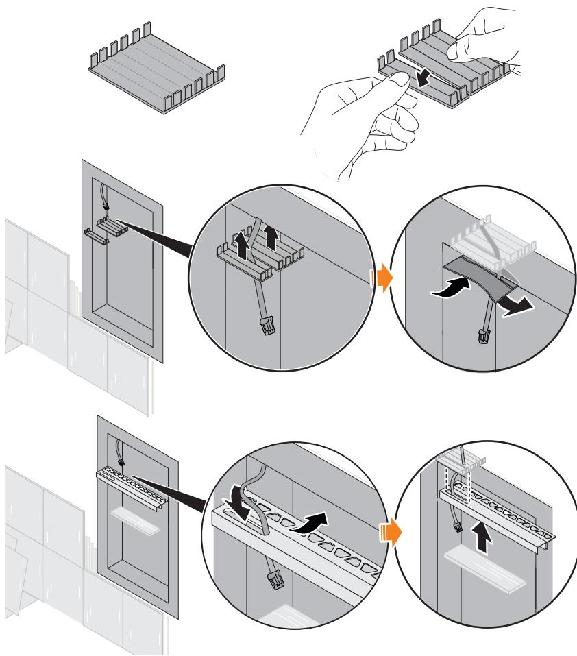
Polohu upevňovacího profilu lze upravit tak, že se víčko průchozí krabice rozdělí v jednom ze stanovených dělicích míst. Při zasazení oddělených částí průchozí krabice se tak může vytvořit mezera. Umístění mezery přitom předurčuje hloubku, kde je ve výklenku zapuštěn upevňovací profil.
