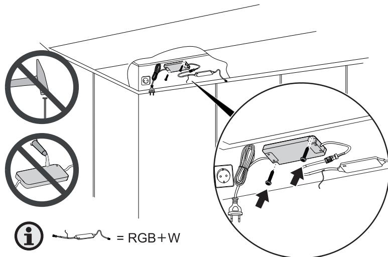
Strømforsyningen skal fastgøres i sin påtænkte position, så der ikke kan opstå noget træk på tilslutningskablet, f.eks. som følge af at strømforsyningen forrykker sig.
