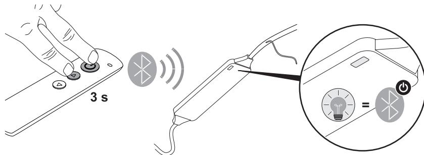
Aby odbiornik Bluetooth mógł nawiązać połączenie Bluetooth z urządzeniem mobilnym (parowanie Bluetooth), należy za pomocą pilota radiowego aktywować funkcję parowania. Aby urządzenie mobilne mogło sterować odbiornikiem Bluetooth, należy zainstalować na nim aplikację Schlüter®-LED-COLOR-CONTROL » „Schlüter®-LED-COLOR-CONTROL“ na stronie 175.
