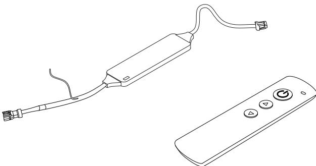
Le récepteur Bluetooth (non compris dans la livraison) peut recevoir les signaux radio de la télécommande et établir une connexion Bluetooth avec un appareil mobile.
