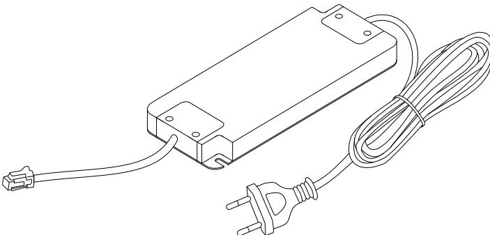
L'alimentatore è un alimentatore a commutazione e trasforma la tensione alternata proveniente dalla rete in una tensione continua da 24 V. L'alimentatore preassemblato è disponibile in diverse varianti di potenza. Il cavo di alimentazione viene collegato a una presa di corrente. Il cavo di collegamento con connettore a spina preassemblato alimenta i componenti collegati.
