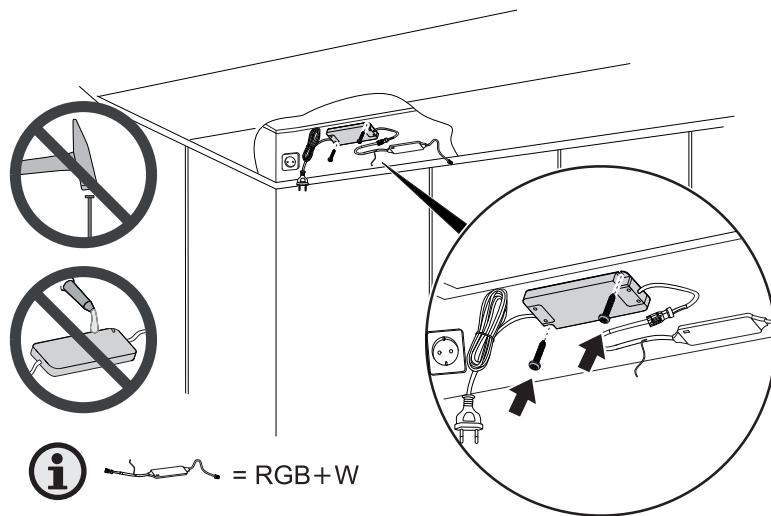
Das Netzteil muss in seiner vorgesehenen Position fixiert werden, damit z. B. durch Verrutschen des Netzteils kein Zug auf die Anschlusskabel entstehen kann.
