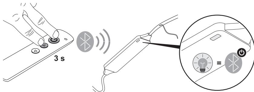
Opdat de Bluetooth-receiver een Bluetooth-verbinding met een mobiel eindapparaat tot stand zou kunnen brengen (Bluetooth-pairing), moet met de afstandsbediening de toestand voor pairing worden geactiveerd. Als de Bluetooth-receiver met een mobiel eindapparaat moet worden gestuurd, moet de app *Schlüter®-LED-COLOR-CONTROL* geïnstalleerd zijn » *"Schlüter®-LED-COLOR-CONTROL"* op pagina 136.
