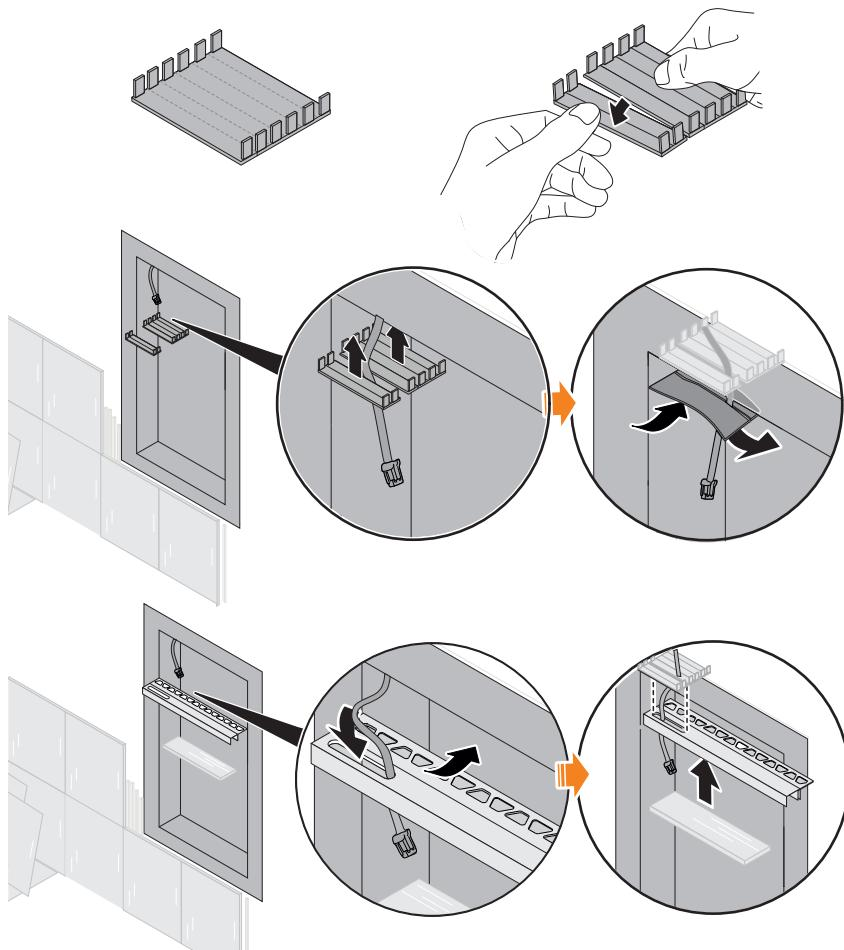
É possível adaptar o perfil de suporte, distribuindo a cobertura da tomada de passagem por um dos locais de separação previstos. Ao colocar as partes separadas da tomada de passagem, pode surgir uma fissura. A posição da fissura determina a profundidade a que o perfil de suporte afunda no nicho.
