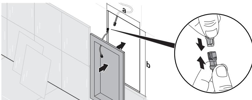
Aby bylo možné pomocí výklenku vytvořit integrované odkládací místo, musí vnější plocha výklenku lícovat se stěnou, v níž je výklenek zabudován. Průchozí krabice instalovaná ve výklenku musí přitom v montážní poloze vždy směrovat nahoru.
