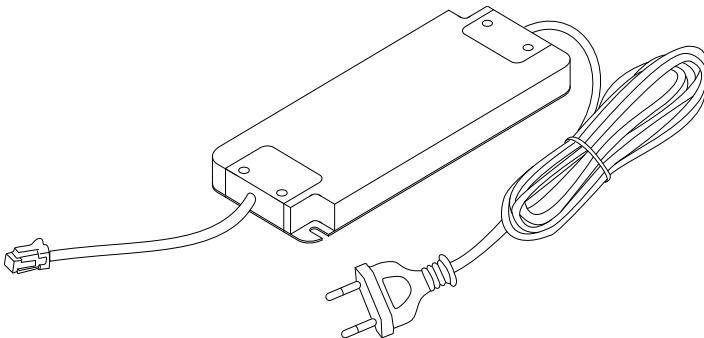
Síťový zdroj pracuje jako spínaný síťový zdroj a převádí síťové střídavé napětí na stejnosměrné napětí 24 V. Předkonfekcionovaný síťový zdroj je k dostání v různých výkonových variantách. Síťový kabel se zapojuje do síťové zásuvky. Již namontovaný připojovací kabel s předkonfekcionovaným konektorem přivádí napětí k připojeným součástem.
