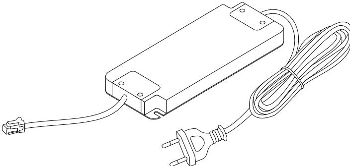
Strømforsyningen arbejder som switch-mode-strømforsyning og transformerer vekselspændingen på netsiden til en jævnspænding på 24 V. Den på forhånd klargjorte strømforsyning fås i forskellige effektvarianter. Strømkablet sættes i en stikkontakt. Det allerede anbragte tilslutningskabel med på forhånd klargjort stikforbinder forsyner de tilsluttede komponenter med spænding.
