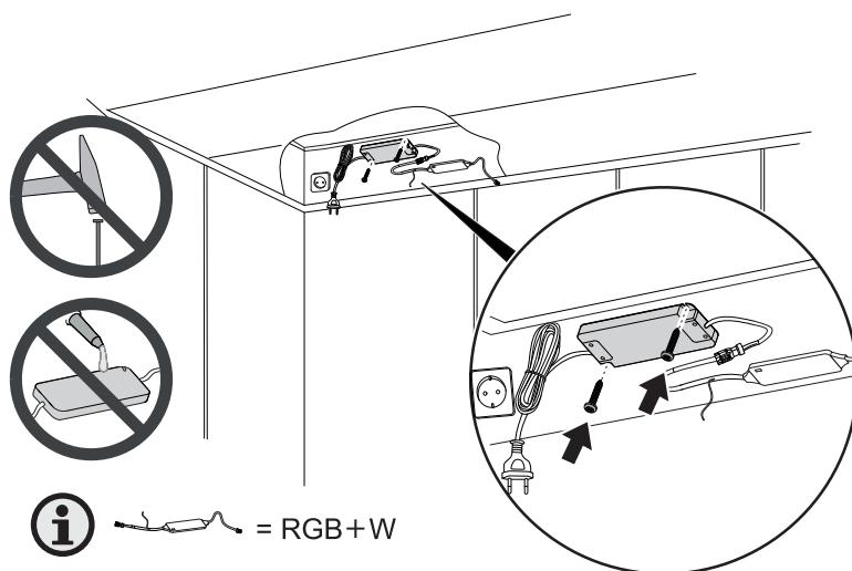
Le bloc d'alimentation doit être fixé dans sa position prévue de manière à ce que, par exemple, le bloc d'alimentation ne puisse pas glisser et tirer sur les câbles de raccordement.
