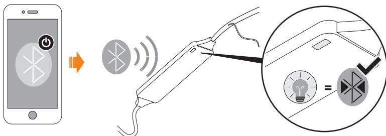
6. Navažte spojení bluetooth mezi mobilním koncovým zařízením a přijímačem bluetooth podle údajů výrobce koncového zařízení.
