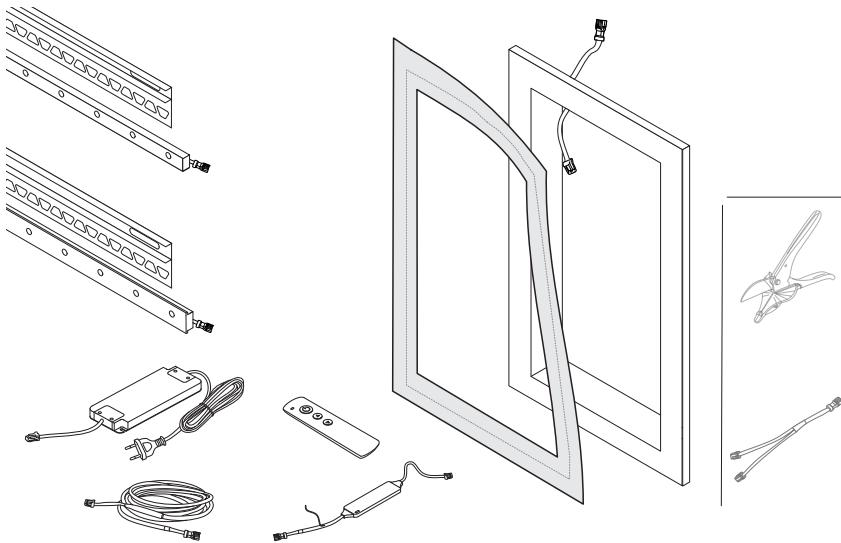
A Schlüter®-KERDI-BOARD-NLT fülkekészettel plug and play elv alapján alakíthat ki hangulatvilágítást. A rendszer ideiglenesen nagy nedvességnek kitett területeken használható. Az előregyártott hálózati adapter a már beépített dugaszolóaljzathoz csatlakoztatható, és 24 V feszültséggel látja el a hozzá csatlakoztatott LED-modulokat.
