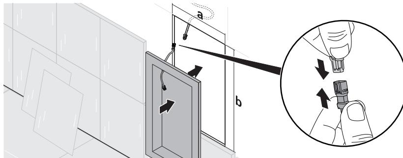
Damit mittels Nische eine integrierte Ablage hergestellt werden kann, muss die Außenfläche der Nische bündig mit der Wand, in der sie eingebaut wird, abschließen. Die in der Nische verbaute Durchgangsdose muss dabei in Einbaulage immer nach oben zeigen.
