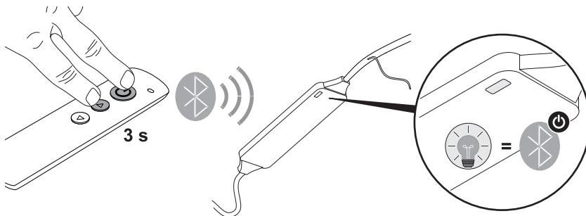
Damit der Bluetooth-Receiver eine Bluetooth-Verbindung mit einem mobilen Endgerät herstellen kann (Bluetooth-Pairing), muss über die Funkfernbedienung die Pairing-Bereitschaft aktiviert werden. Wenn der Bluetooth-Receiver mittels mobilem Endgerät gesteuert werden soll, muss die App Schlüter®-LED-COLOR-CONTROL installiert sein » „Schlüter®-LED-COLOR-CONTROL“ auf Seite 22.
