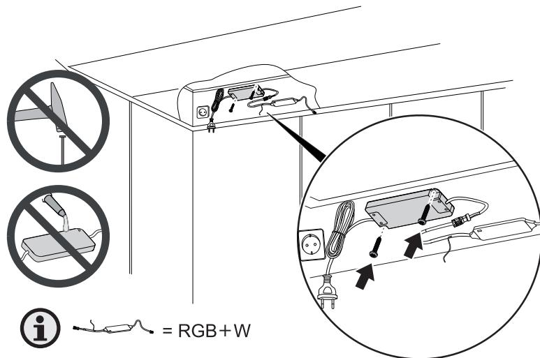
La fuente de alimentación se debe fijar en su posición prevista para que no se produzca ninguna tracción en el cable de conexión, p. ej., a causa de un deslizamiento de la fuente de alimentación.
