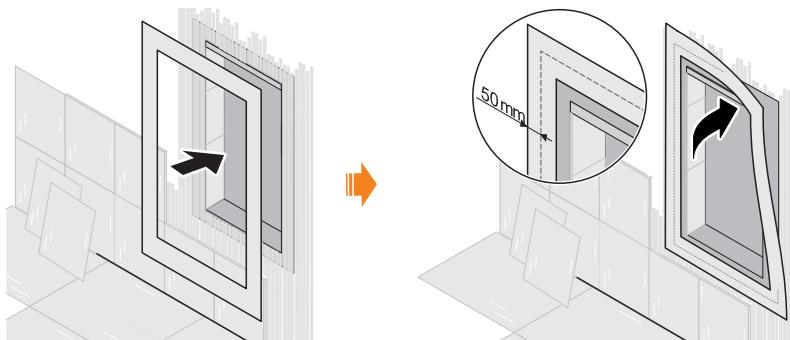
1. Controleren of de nis permanent met de montageplaats verbonden is.
