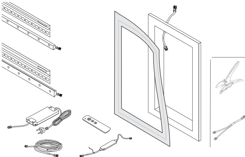
Se sadou s výklenkem Schlüter®-KERDI-BOARD-NLT je možné vytvářet akcentové osvětlení na principu plug-and-play. Systém je vhodný pro použití v oblastech s občasní vysokou vlhkostí. Předkonfekcionovaný síťový zdroj lze zapojit do již instalovaných zásuvek a napájí připojené LED-moduly napětím 24 V.
