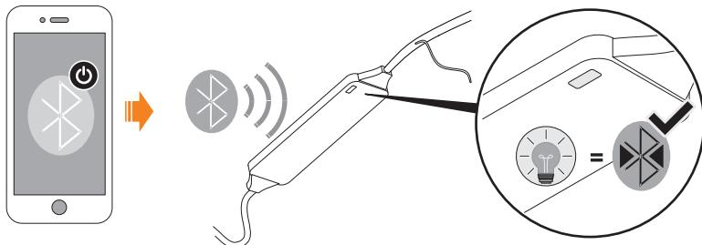
6. Bluetooth-Verbindung zwischen mobilem Endgerät und Bluetooth-Receiver nach Vorgaben des Herstellers herstellen.
