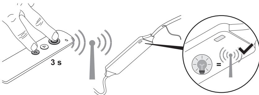
4. Auf der Funkfernbedienung Tasten EIN/AUS und AB ca. 3 s gleichzeitig gedrückt halten.
