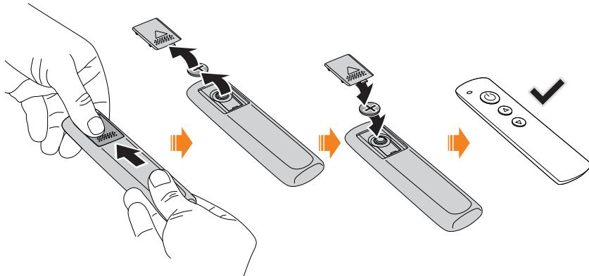
Substitua uma pilha descarregada (» “Dados técnicos da pilha” na página 271) conforme mostrado.
