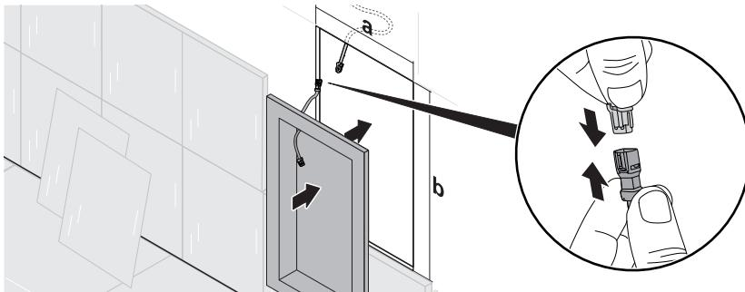
For at der kan etableres en integreret hylde ved hjælp af nichen, skal nichens udvendige flugte med væggen, hvor den monteres. Gennemgangsdåsen, der er monteret i nichen, skal i den forbindelse altid vende opad i monteringspositionen.
