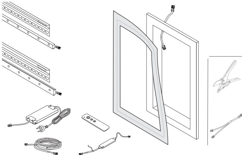
Mit dem Schläuter®-KERDI-BOARD-NLT-Nischen-Set können nach dem Plug-and-Play-Prinzip Akzentbeleuchtungen hergestellt werden. Das System ist für den Einsatz in Bereichen mit zeitweise hoher Feuchtigkeit geeignet. Das vorkonfektionierte Netzteil kann in bereits verbauten Steckdosen eingesteckt werden und versorgt die angeschlossenen LED-Module mit einer Spannung von 24 V.
