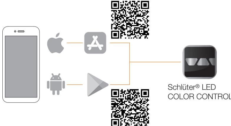
Schlüter®-LED-COLOR-CONTROL är en app för mobila enheter som kan användas för att styra LED-systemet.
