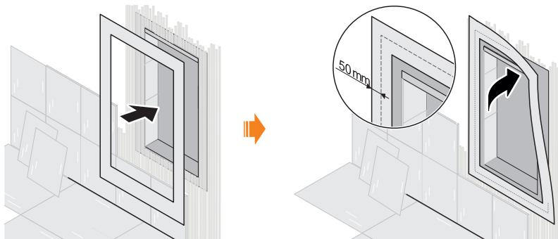
1. Sicherstellen, dass die Nische dauerfest mit dem Einbauort verbunden ist.
