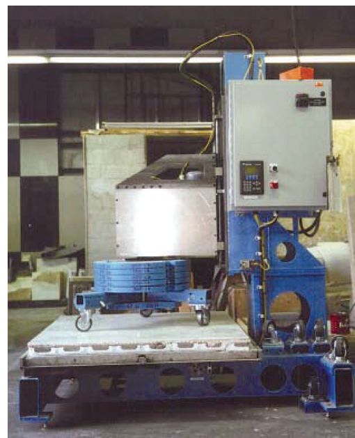
Testeur de plancher universel pouvant effectuer le test de plancher Robinson selon la norme ASTM C627, où l'on peut voir un système de plancher flottant.
