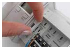
Exemple de remplacement du fusible du module de base Control.
