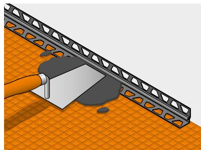
**16.** Für keramische Beläge/Naturstein: Verlegung der Entkopplungsmatte Schlüter-DITRA in frischem Dünnbettmörtel nach Begehbarkeit des Estrichs. Bei Calciumsulfatestrich nach einer Restfeuchte von  $\leq 2\%$ .
