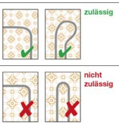
**11.** Beim Einbringen der systemzugehörigen Heizrohre mit ø 14 mm bzw. 16 mm sind diese in doppeltem Verlegeabstand bis zur Wendeschleife zu legen. Nach der Wendeschleife wird der Rücklauf (blaue Darstellung) im verbliebenen Freiraum mittig eingelegt. Wichtig: Umlenkung der Heizrohre gemäß Darstellung!
