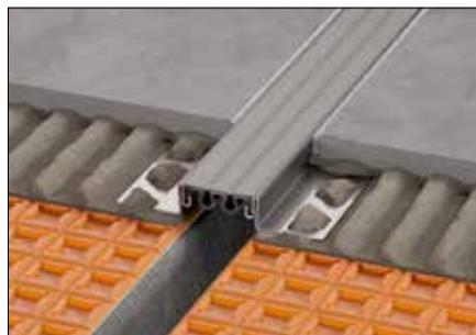
Schlüter-DILEX-KSBT ist ein Bautrennfugenprofil mit Kantenschutz, bestehend aus seitlichen Befestigungsschenkeln aus Aluminium oder Edelstahl, die mit einer 20 oder 30 mm breiten Bewegungszone aus weichem Kunststoff verbunden sind (siehe Produktdatenblatt 4.19).
