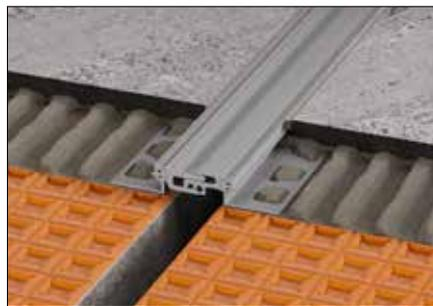
Schlüter-DILEX-BT ist ein Bautrennfugenprofil oder Aluminium mit seitlicher Gelenkanbindung des ineinander verschiebbaren Mittelteils. Somit ist eine dreidimensionale Bewegungsaufnahme möglich (siehe Produktdatenblatt 4.20).
