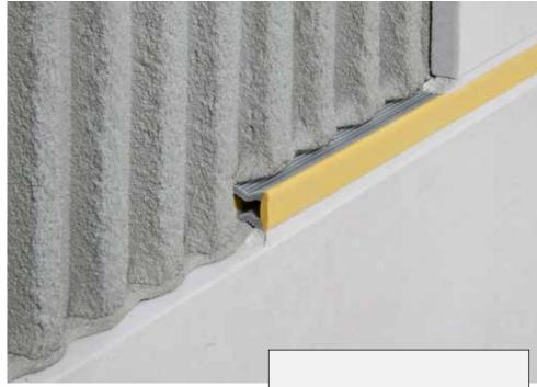
Die Weich-PVC-Verbindungen überdecken die Seitenteile aus Hart-PVC und sind oben und unten in verschiedenen Farben ausgebildet. So hat jeweils ein Profil zwei unterschiedliche verwendbare Sichtflächen. Die Verwendbarkeit des vorgesehenen Profiltyps ist in besonderen Einzelfällen je nach zu erwartenden chemischen, mechanischen oder sonstigen Belastungen zu klären.
