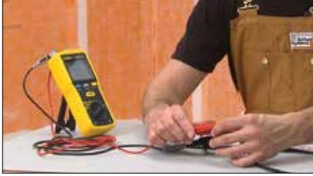
**1** Avant de tirer le câble chauffant hors de la bobine, effectuez le premier test et consignez-en le résultat dans le registre de test du câble chauffant, à la page 39. Si un bris ou un dommage est décelé au moment des tests, retournez le câble au point d'achat d'origine.
