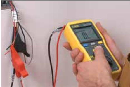
**4** Une fois la pose des câbles chauffants et des capteurs thermiques au sol effectuée, reprenez les tests et consignez leurs résultats dans le registre de test de câble chauffant (page 39).
