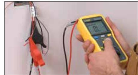
**7** Une fois l'installation des câbles chauffants et des capteurs thermiques au sol réalisée, reprenez les tests et consignez leurs résultats dans le registre de test du câble chauffant (page 39).
