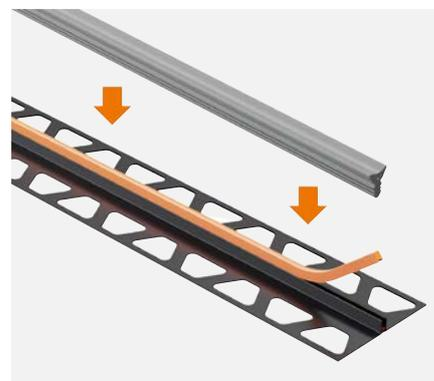
On obtient ainsi des joints de mouvements sans interruption visuelle. Étroit, élégant et fonctionnel : Schlüter-DILEX-F est idéal pour la réalisation de joints fins.
