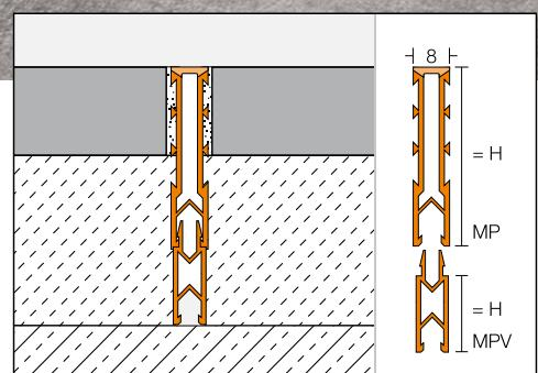
DILEX-MP/-MPV wird als Dehnungsfuge in Fliesen- und Plattenbelägen verarbeitet, die im Mörtelbett verlegt werden. Das Profil trennt die einzelnen Belagsfelder und gleicht in dem Mittelteil aus Weich-CPE entsprechend auftretende Druckspannungen aus.
