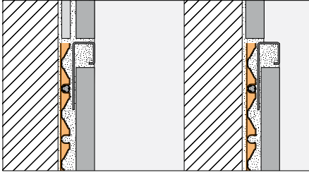
Montaj varyantı: duvar sınır profili Schlüter®-QUADEC
