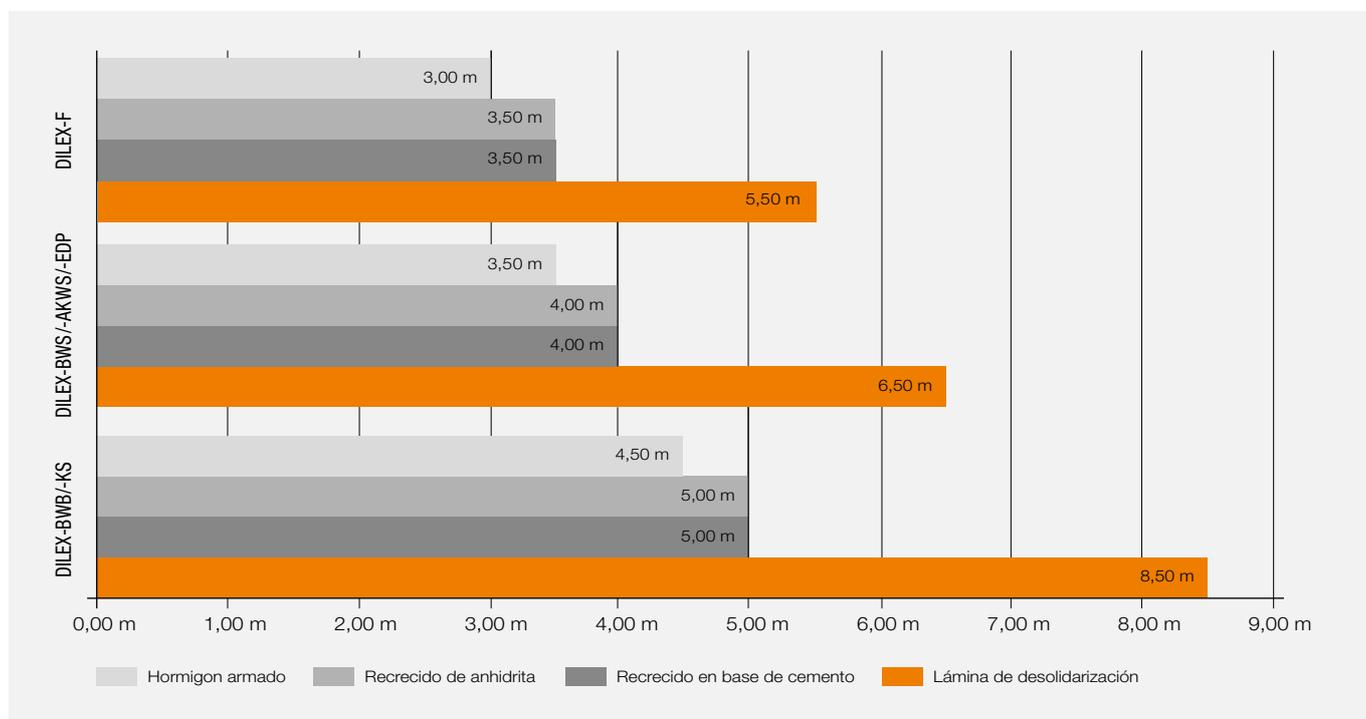
\* Las longitudes de los paños se determinan según la fórmula indicada con un coeficiente de dilatación medio por cada componente, un coeficiente de seguridad de 0,6 y redondeado a 0,5 m.
