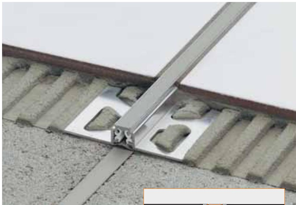
Os perfis de fixação laterais são sensíveis a substâncias alcalinas. Os materiais à base de cimento desenvolvem propriedades alcalinas sob a influência de humidade e, dependendo da concentração e do tempo de actuação, podem dar origem à corrosão (formação de hidróxido de alumínio). O perfil deve assentar por completo na camada de contacto com a tijoleira.
