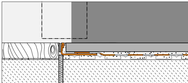
Se requiere una solución «sin barreras» conforme a la norma DIN en forma de remate impermeable con un revestimiento cerámico al mismo nivel (cota cero).
