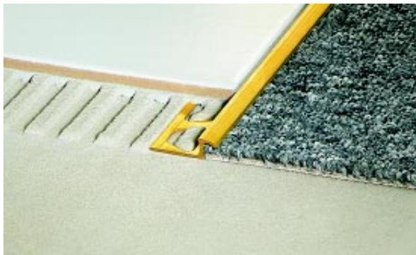
che in funzione della concentrazione e della durata di esposizione possono corrodere (formazione di idrossido di alluminio) il profilo. Pertanto qualsiasi residuo di prodotto cementizio e di sigillante, deve essere rimosso immediatamente; inoltre il profilo deve essere posato in modo tale che non rimangano cavità all'interno delle quali si possa accumulare acqua con conseguente formazione di sostanze alcaline e successiva corrosione dello stesso.
