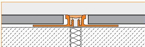
**4.8 Schluter®-DILEX-KSN** possède des ailettes d'ancrage en acier inoxydable ou en aluminium, perforées de trous en forme de trapèze. Ces
