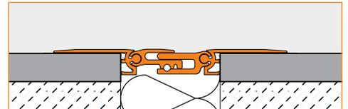
**Schluter®-DILEX-BTS** est ajouté à des revêtements finis existants. Ce profilé peut être inséré dans des joints existants. Les joints doivent être d'une largeur d'au moins 1 3/4" (44 mm) et d'une profondeur d'au moins 3/8" (10 mm).
