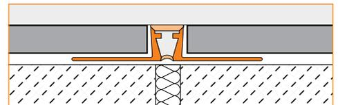
**4.6 Schluter®-DILEX-BWB** possède des ailettes d'ancrage en PVC rigide recyclé, perforées de trous en forme de trapèze. Ces ailettes d'ancrage s'enfoncent dans le ciment-colle et protègent les rebords des carreaux de céramique adjacents. Le profilé divise la surface de carreaux en sections individuelles. Il est composé d'une zone centrale flexible faite de polyéthylène chloruré flexible (CPE) qui permet les mouvements. Cette zone de mouvement
