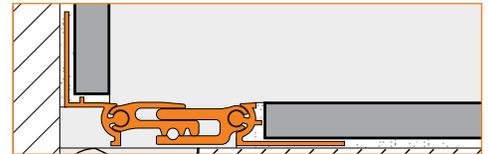
**Schluter®-DILEX-BT/O**, une variante du profilé, peut être utilisé pour créer des joints d'expansion aux transitions sol/mur.
