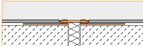
Le **Schluter®-DILEX-EKSB** qui possède des ailettes d'ancrage en acier inoxydable est disponible en différentes hauteurs: 3/32" (2.5 mm), 3/16" (4.5 mm) et 1/4" (6 mm). Ceci convient aux revêtements de plancher plus minces (c.-à-d., les revêtements de plancher tuiles de vinyle (VCT) ou les revêtements de peinture). Le DILEX-EKSB s'utilise autant dans le domaine résidentiel que commercial moyen.
