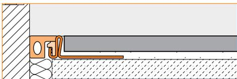
**4.9 Schluter®-DILEX-KSA** possède une ailette d'ancrage en acier inoxydable ou en aluminium, perforée de trous en forme de trapèze qui s'enfoncent dans le ciment-colle et qui protège le côté exposé des carreaux adjacents. Une bande autoadhésive à l'endos du profilé permet de le coller sur les éléments de fixation comme les cadres de portes et fenêtres, baignoires, bases de douches, comptoirs, etc. Le profilé divise la surface de
