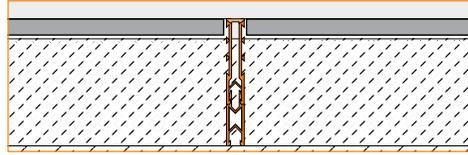
**4.3 Schluter®-DILEX-MP** s'ajuste à l'épaisseur du lit de mortier ainsi qu'à la surface du revêtement de carreaux de céramique. Il suffit d'ajouter les rallonges DILEX-MPV au profilé. Le profilé présente une zone centrale de mouvement, faite de polyéthylène chloruré flexible (CPE) qui recouvre d'approximativement 1/32" (1 mm) les parois latérales en PVC rigide recyclé. La surface de ce profilé est plus esthétique comparativement au DILEX-MOP.
