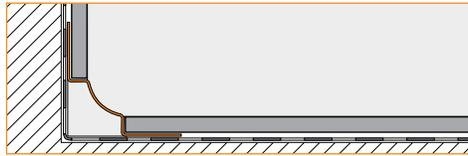
**4.15 Schluter®-DILEX-EHK** possède des ailettes d'ancrage en acier inoxydable perforées de trous en forme trapèze qui s'enfoncent dans ciment-colle. Le DILEX-EHK possède aussi une section arrondie visible en acier inoxydable. Le rayon du profilé de 23/32" (18.5 mm) empêche l'accumulation de la saleté et facilite le nettoyage. Le profilé sépare les surfaces de carreaux de céramique qui se rencontrent aux coins internes où les mouvements sont limités.
