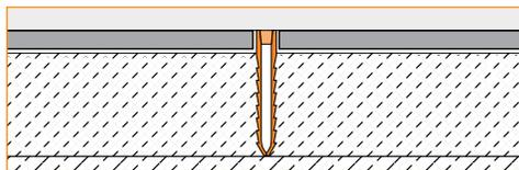
**4.4 Schluter®-DILEX-MOP** est offert en trois différentes hauteurs et est doté de parois latérales dentelées stables, faites de PVC rigide, ainsi que d'une zone centrale faite de PVC flexible permettant les mouvements. Les parois latérales sont faites de
