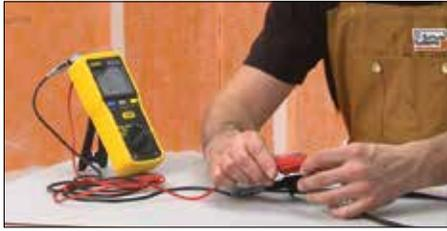
**1** Antes de retirar el cable de calefacción de la bobina, se debe llevar a cabo el primer grupo de pruebas requeridas y se deben anotar los valores en el registro de pruebas al cable de calefacción (página 39). Si se detecta alguna defecto o daño durante las pruebas, devolver el cable de calefacción al establecimiento donde lo compró.
