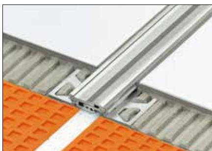
Schlüter-DILEX-BT è un giunto strutturale in alluminio con profili di supporto laterali che si connettono ad una sezione centrale telescopica, consentendo così l'assorbimento del movimento tridimensionale (vedi scheda tecnica 4.20).
