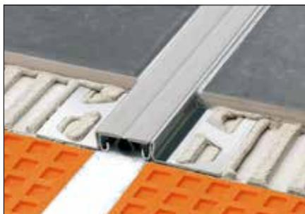
Schlüter-DILEX-KSBT è un giunto strutturale con parte dilatante in gomma sintetica di 20 o 30 mm e con funzione di protezione laterale del bordo piastrella. Interrompe la pavimentazione e riduce la trasmissione del suono da calpestio nella pavimentazione (vedi scheda tecnica 4.19).
