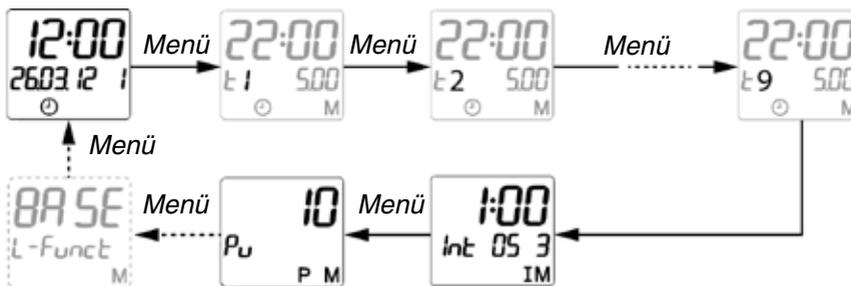
Figura 3: Estructura de navegación del menú
